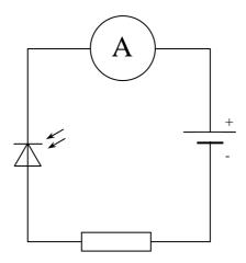
2) Une photodiode branchée en inverse laisse passer un courant d'autant plus intense qu'elle est plus éclairée. L'intensité du courant augmente donc lorsque l'éclairement augmente.
