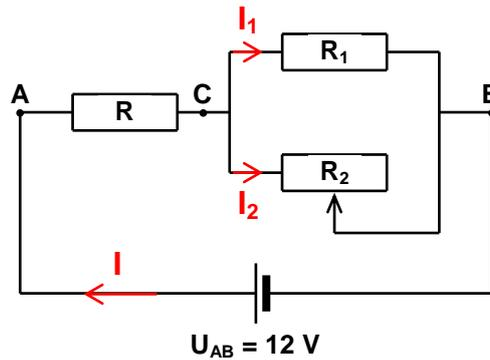
On se place dans le cas où  $R_2 = 150 \Omega$ , la résistance équivalente à l'ensemble du circuit a pour valeur  $R_{eq} = 225 \Omega$  ; calculer :
