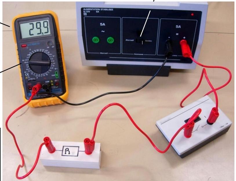
2) a) Schématiser le circuit.
