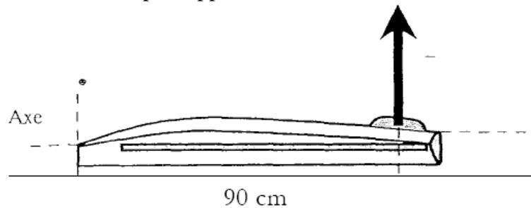
3) Un dispositif conçu pour les personnes ne disposant que d'un bras valide permet de tourner le volant d'une voiture à l'aide d'une boule fixée sur le volant. (voir figure). Le volant tourne dès qu'un moment de 3 N.m est appliqué.
