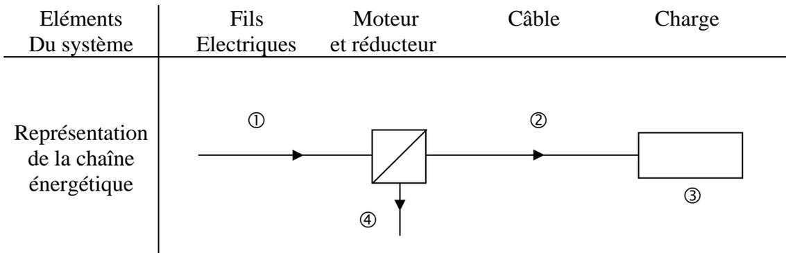
2) L'énergie transférée  $W_u$  en ② est égale à l'augmentation d'énergie de la charge donnée par la relation  $E_p = m \times g \times h$ , dans laquelle  $m$  est la masse de la charge,  $h$  la hauteur de levage et  $g = 9,81\text{N/kg}$ .
