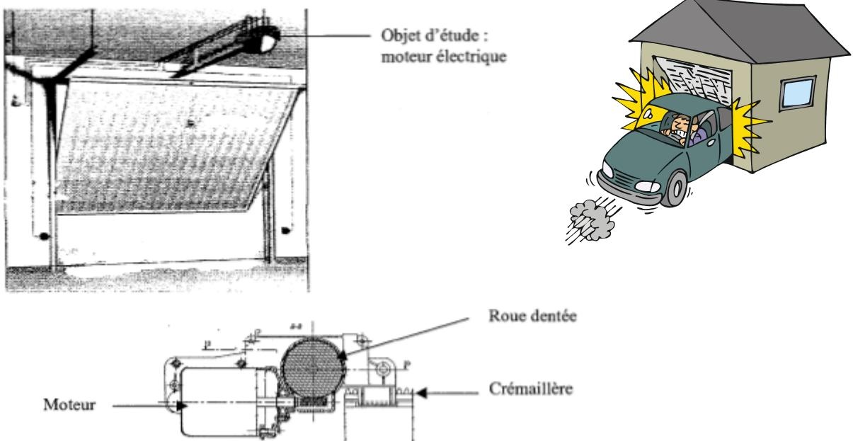
Sur la plaque signalétique d'un moteur, qui entraîne une porte basculante, sont indiquées les caractéristiques suivantes :
