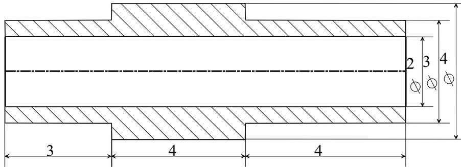
1) Avant usinage, on a un cylindre creux en acier:
