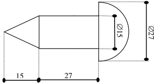
Les rivets fabriqués par l'entreprise sont constitués d'un cône, d'un cylindre et d'une demi-sphère.
